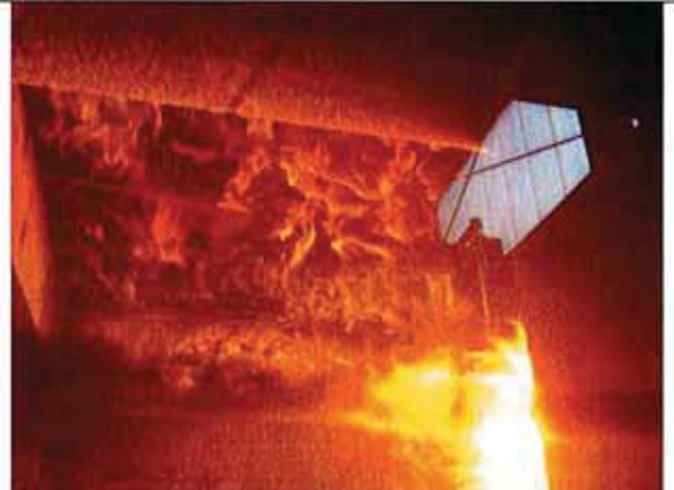
Bild 6: 9. Prüfminute. Die Lamellen der geritzten Akustiklage (Holzlattung) sind fast vollständig abgefallen, Eigenbrand an der darunter befindlichen Holzweiche-faserplatte.
