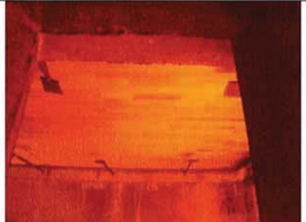
Bild 2: 2. Prüfminute. Beginnende Verfärbung an der Holzlattung der Akustiklage.
