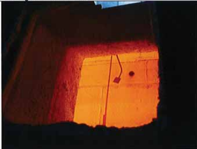
Bild 15: 20.Prüfminute. Fugenspachtel wieder komplett aufgehell, dieser löst sich leicht von der Plattenoberfläche. Blick auch auf die Kaiserdose im oberen Wandbereich. Sichtbares Reagieren des Brandschutzbildners der Kaiserdose.
