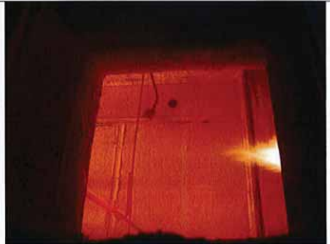
Bild 16: 26.Prüfminute. Fugenspachtel wieder komplett aufgehell, dieser löst sich leicht von der Plattenoberfläche. Blick auch auf die Kaiserdose im oberen Wandbereich. Sichtbares Reagieren des Brandschutzbildners der Kaiserdose.
