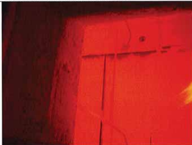
Bild 17: 31.Prüfminute. Fugenspachtel teilweise heraus gefallen. Schwarzfärbung der Plattenfugen in diesem Bereich erkennbar.
