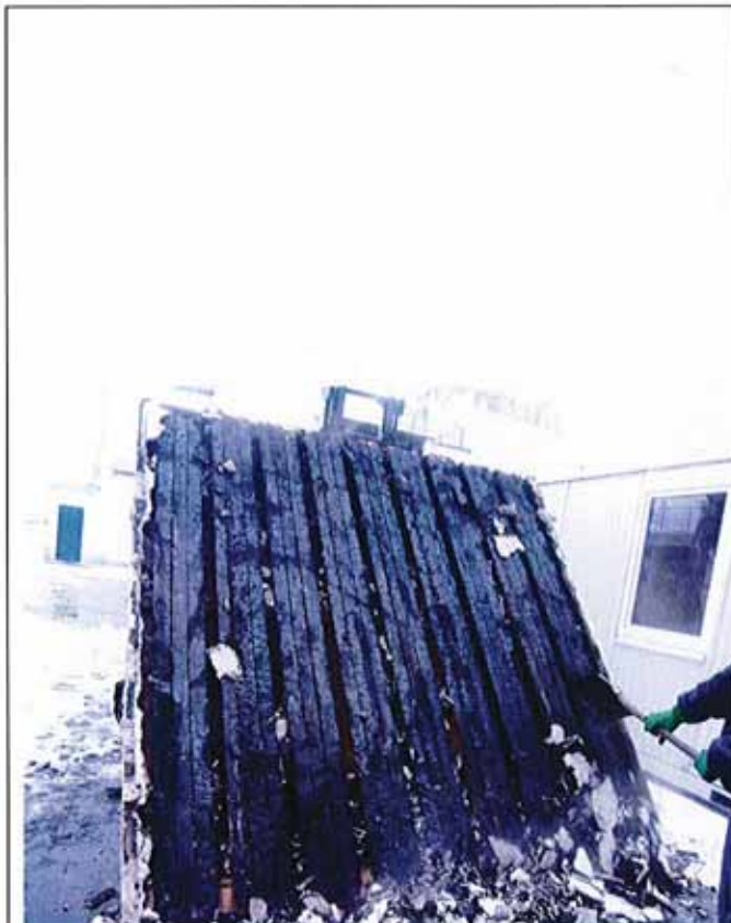
Bild 19: Prüfungsende. Ansicht der feuerzugewandten Seite nach entfernen der 15 mm dicken GKF-Plattenbekleidung.
