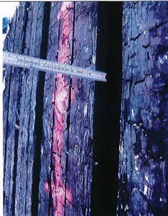
Bild 20: Prüfungsende. Detailansicht des Abbrandes an der Oberfläche auf der mittleren Wandbreite.
