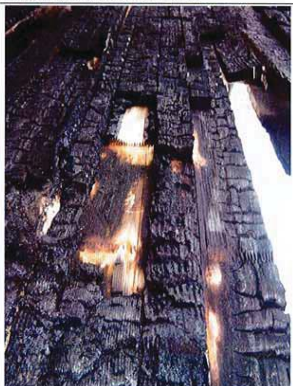
Bild 4: Blick auf den Untergurt. Holzschalung im Bereich der Stege noch gute Verbindungen im Bereich des Untergurtes. Versagen der Holzschalung des Untergurtes im Bereich des Deckenhohlraumes (durch fehlenden Anpressdruck bei der Herstellung).
