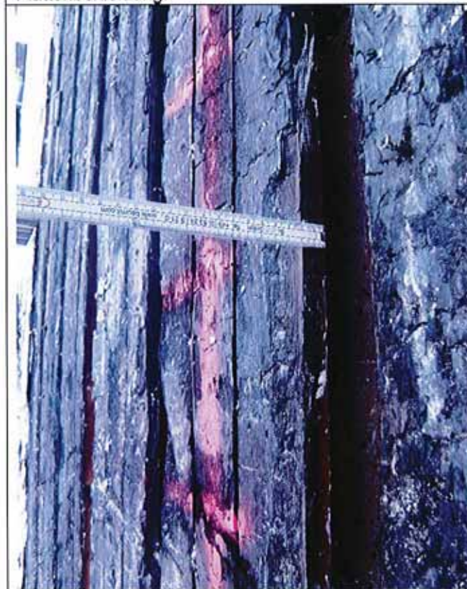
Bild 21: Prüfungsende. Detailansicht des Abbrandes an der Oberfläche auf der mittleren Wandbreite.
