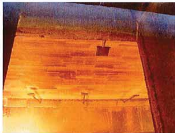
Bild 3: 2. Prüfminute. Oberfläche der Akustiklage fast vollständig schwarz verfärbt.
