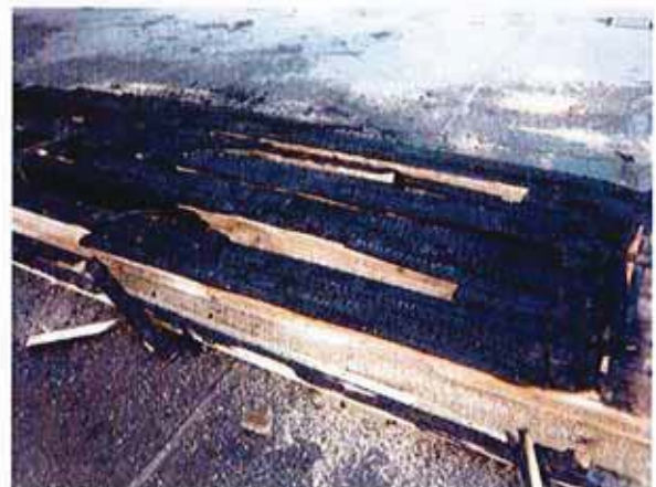
Bild 2: Blick auf ein Deckenelement. Teilweise Einbrand in den Deckenhohlraum.
