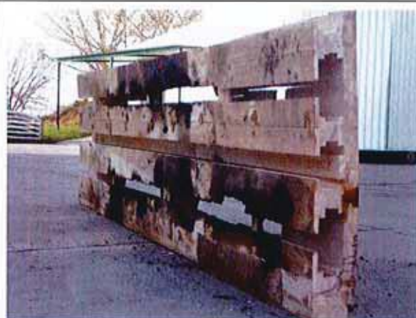
Bild 6: Blick auf ein Deckenelement von der feuerabgewandten Seite. Teilweise Einbrand in den Deckenhohlraum und Durchbrand, nach versagen des Untergurtes und herausfallen der Kiesschüttung, bis zur oberen Holzweichfaserabdeckung.
