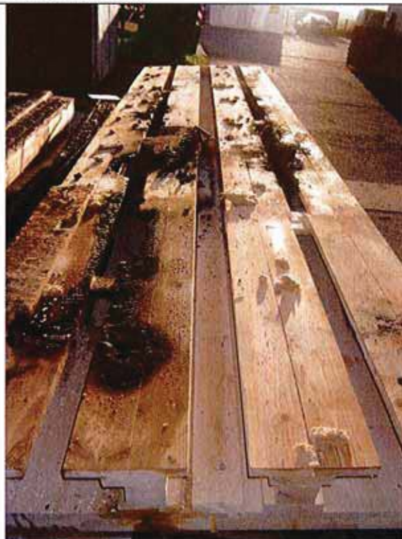
Bild 3: Blick auf ein Deckenelement von der feuerabgewandten Seite. Teilweise Einbrand in den Deckenhohlraum und Durchbrand, nach versagen des Untergurtes und herausfallen der Kiesschüttung, bis zur oberen Holzweichfaserabdeckung.
