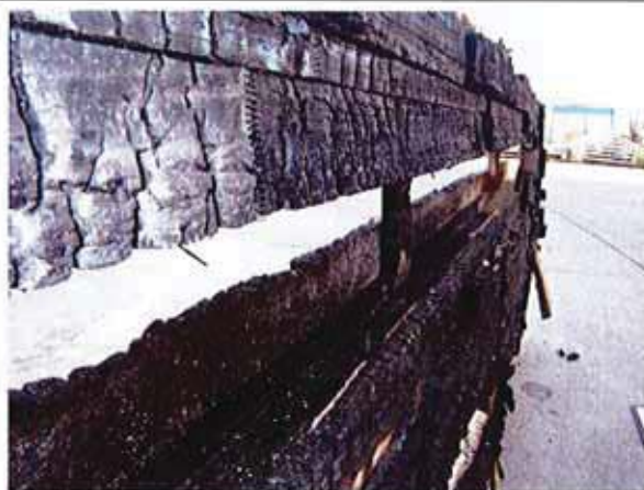
Bild 5: Blick auf ein Deckenelement von der feuerzugewandten Seite. Sichtbarer Einbrand in den Deckenhohlraum und Durchbrand, nach versagen des Untergurtes und herausfallen der Kiesschüttung, bis zur oberen Holzweichfaserabdeckung.
