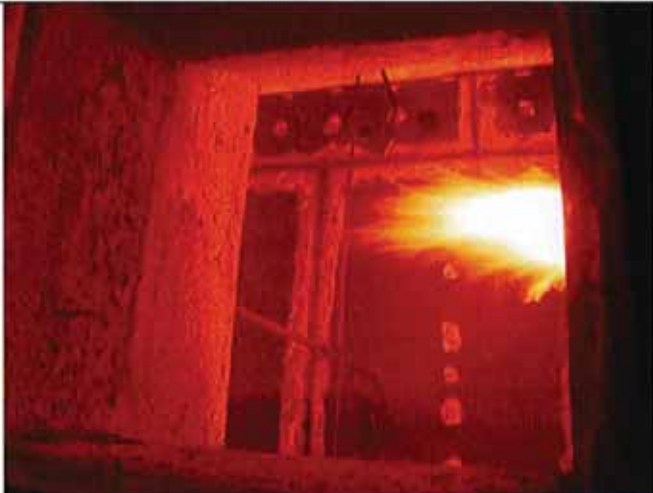
Bild 13: 8.Prüfminute. Deckpapier beginnt sich von der Oberfläche der Gipskarton-Feuerschutzplatten abzulösen. Fugenspachtel direkt im Bereich der Stoßfugen dunkel verfärbt.
